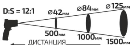
При измерении термометр будет излучать свет в виде кольц-индикатора. Измеренная температура – это температура поверхности объекта в пределах кольца.
