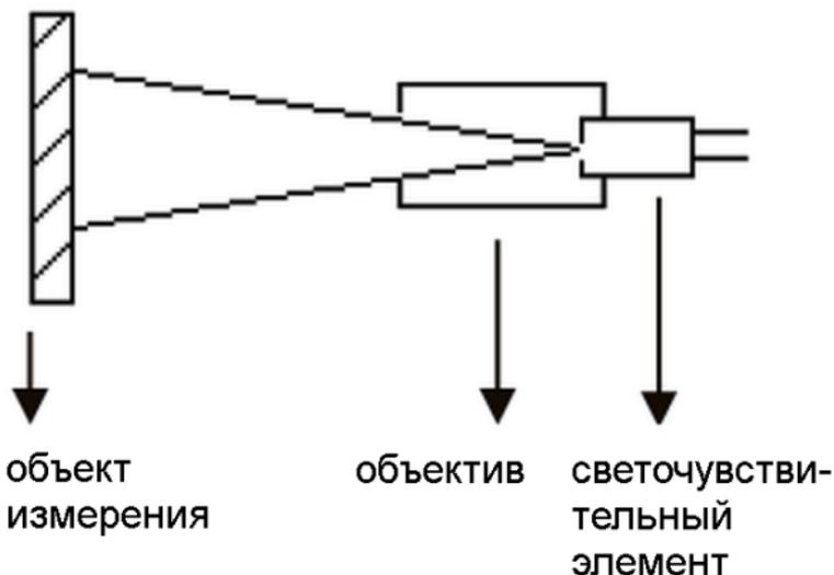
Необходимо удостовериться, что обследуемый объект целиком перекрывает поле зрения термометра, и в поле зрения не попадает ничего, кроме объекта. Чем больше объект измерения, тем больше может быть расстояние между ним и термометром при измерении температуры. Чем меньше объект, тем ближе к нему необходимо размещать термометр. Соотношение между расстоянием до объекта и его размером ( $D:S$ ) составляет 12:1, как показано на следующей схеме:
