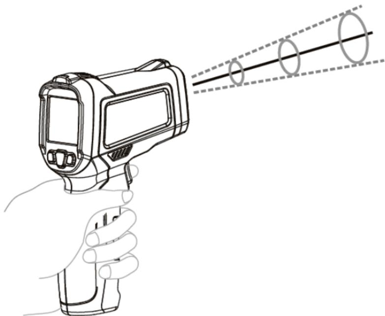
Когда кнопка запуска измерений нажата, на дополнительном индикаторе дисплея сначала отображается установленный коэффициент излучения, а затем максимальная измеренная температура.
